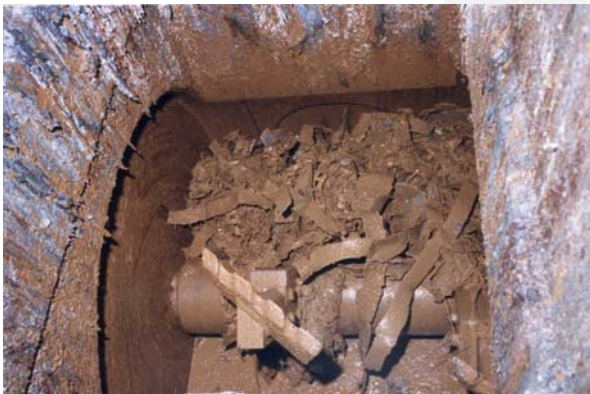
Blick in einen laufenden AVA 10 m 3 Mischer: Sonderabfall, während des Mischvorganges nach der Behandlung mittels Rotorschere
