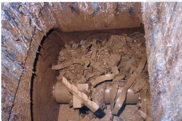
Вид на работающий смеситель AVA емкостью 10 м 3 : специальные отходы во время процесса смешивания после обработки роторными ножницами
